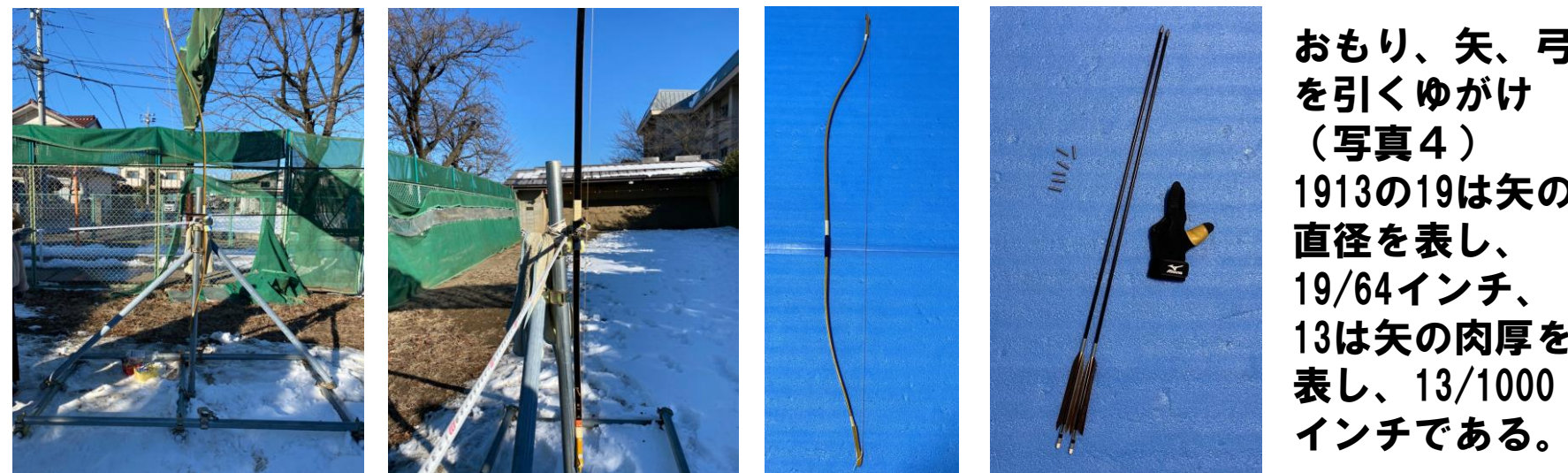
鉄パイプを接続した弓を装着した装置(正面)(写真2) 直心ハンパー10.5kg(写真3) 弓を装着した装置(側面)(写真1)
