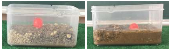
図11 (左)地震発生前 (右)地震発生後
