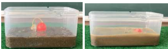
図9 (左)地震発生前 (右)地震発生後
