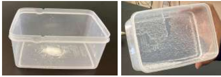
図12 吸水性ポリマーに水を入れたもの
